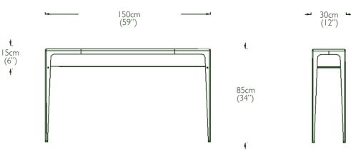
rectangular 150cm: overall - 150cm w  $\times$  30cm d  $\times$  85cm h (59" w  $\times$  12" d  $\times$  34" h)
